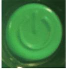
**电源：**主电源开关用于启用或切断服务器系统的供电。使用此按钮关闭系统电源可切断主电源但保持备用电源为系统供电。因此，您必须在检修前拔掉系统电源插头。
